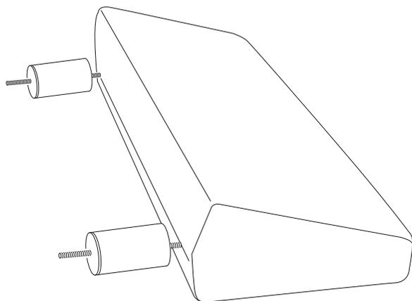
**3** Закрепить спинку дивана к сидению дивана гайками M8 через шайбы, затянуть ключом торцевым (подтягивать в процессе эксплуатации)
